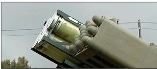
Лансер опремљен једним контејнером ACCULAR и једним EXTRA, приказује флексибилност комбиновања ових система
