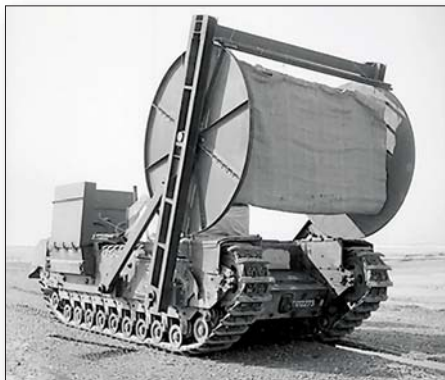
„Черчил“ са наградњом „Bobbin“ Mk. I обременен за савладавање високог газа
